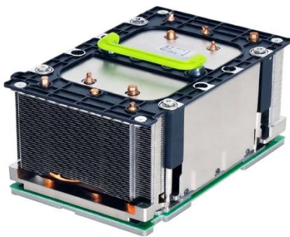
图 2.15 板载集成型 AI 加速模组设计实例
