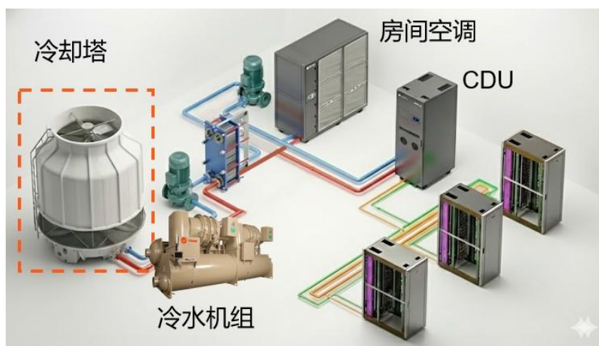
图 1.8 水冷冷水机组冷源方案
