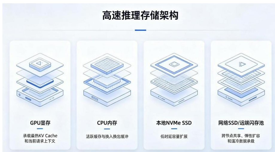
图 2.31 高速推理存储四层架构示意图
